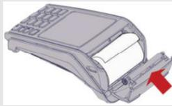
2. Entfernen Sie die leere Papierrolle und legen Sie die neue entsprechend der Abbildung ein.
