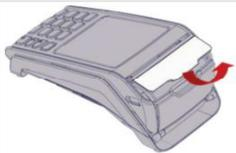
1. Öffnen Sie den Deckel des Druckers, indem Sie die Klappe nach oben ziehen.
