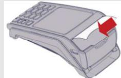
3. Schließen Sie den Druckerdeckel durch leichtes Drücken, bis dieser hörbar einrastet.
